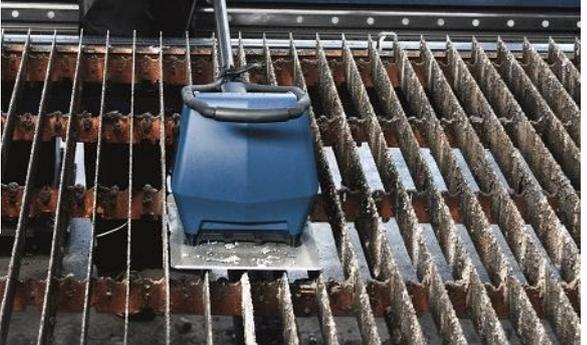
Blech mit dem Laser schneiden und nachhaltig Leisten reinigen, statt teuren Stahl zu verschwenden! Mit dem TRUMPF Auflageleisten-Reiniger entfernen Sie die bei Laserschneidanlagen anfallende Schlacke gründlich und schnell. Ihre „teuren“ Leisten sind dadurch bis zu viermal länger im Einsatz und die Qualität beim bearbeiteten Blech ist zudem höher.
